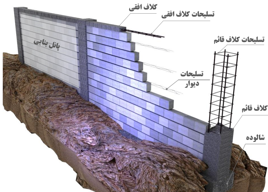
شکل ۱-۲ - قسمت‌های اصلی دیوارهای محوطه بنایی
